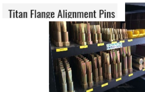
ตัวอย่างอุปกรณ์ที่ใช้ช่วยในการใส่(line up Pin) และถอด (Spreader) Flange
